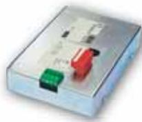
Las **tarjetas de red externas Profibus-DP, Interbus-S y CAN** permiten **conectar cualquier terminal ESA** de la familia VT, que no cuente con puerto de red integrado, **al bus de campo especificado**. De esta manera es posible integrar el terminal a una red dedicada, incluso en aquellos casos en los que ese requisito no estaba previsto originariamente.
